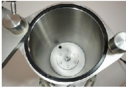
Ablassöffnung für Luft / Wasserboden
