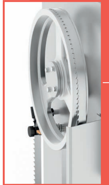
Poleas inoxidable con doble pestaña. Stainless steel pulleys with double rim. Poulies en acier inoxydable avec double rebord. Edelstahl Laufrad mit Doppelbord.
